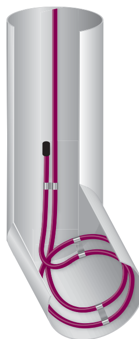
Рис. 30. Схема укладки кабеля внизу водосточной трубы
