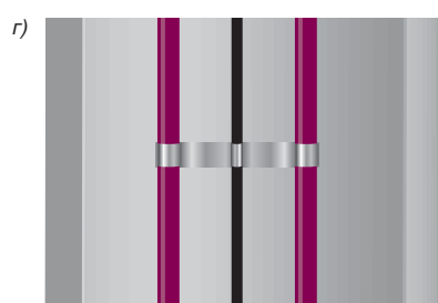
Зажим для крепления одной нитки кабеля в водосточной трубе с применением троса
