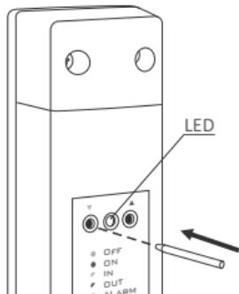
1. Сопряжение регулятора **2030 RTH** с приемником **RTH** инициируется нажатием левой кнопки сопряжения (зеленый треугольник - ▼) на приемнике RTH и ее удержанием в течение не менее 2 с, до тех пор, пока не начнет мигать зеленый светодиод, после чего мы отпускаем кнопку.
