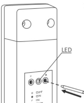
1. Отмена сопряжения регулятора **2030 RTH** с приемником **RTH** инициируется нажатием правой кнопки отмены сопряжения (красный треугольник - ▲) на приемнике и ее удержанием в течение не менее 2 с, до тех пор, пока не начнет мигать красный светодиод, после чего мы отпускаем кнопку.
