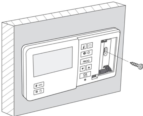
**Внимание:** Если стена деревянная, нет необходимости в использовании дюбелей. Достаточно высверлить отверстия диаметром 2,7 мм (вместо 6 мм) и шурупы ввинтить непосредственно в дерево.
