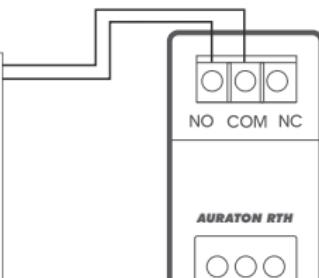
Упрощенная схема подключения **AURATON RTH** к нагревательному оборудованию (беспотенциальный вход)
