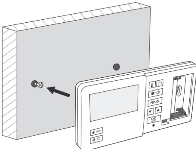
5. Ввинтить правый шуруп так, чтобы он хорошо держал установленный регулятор.
