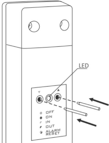
Для отмены сопряжения всех сопряженных устройств в приемнике **RTH** необходимо одновременно нажать и удерживать нажатыми обе кнопки сопряжения и отмены сопряжения (▼ и ▲) в течение не менее 5 с, до тех пор, пока не появится попеременное мигание зеленого и красного светодиода. После этого следует отпустить обе кнопки.
