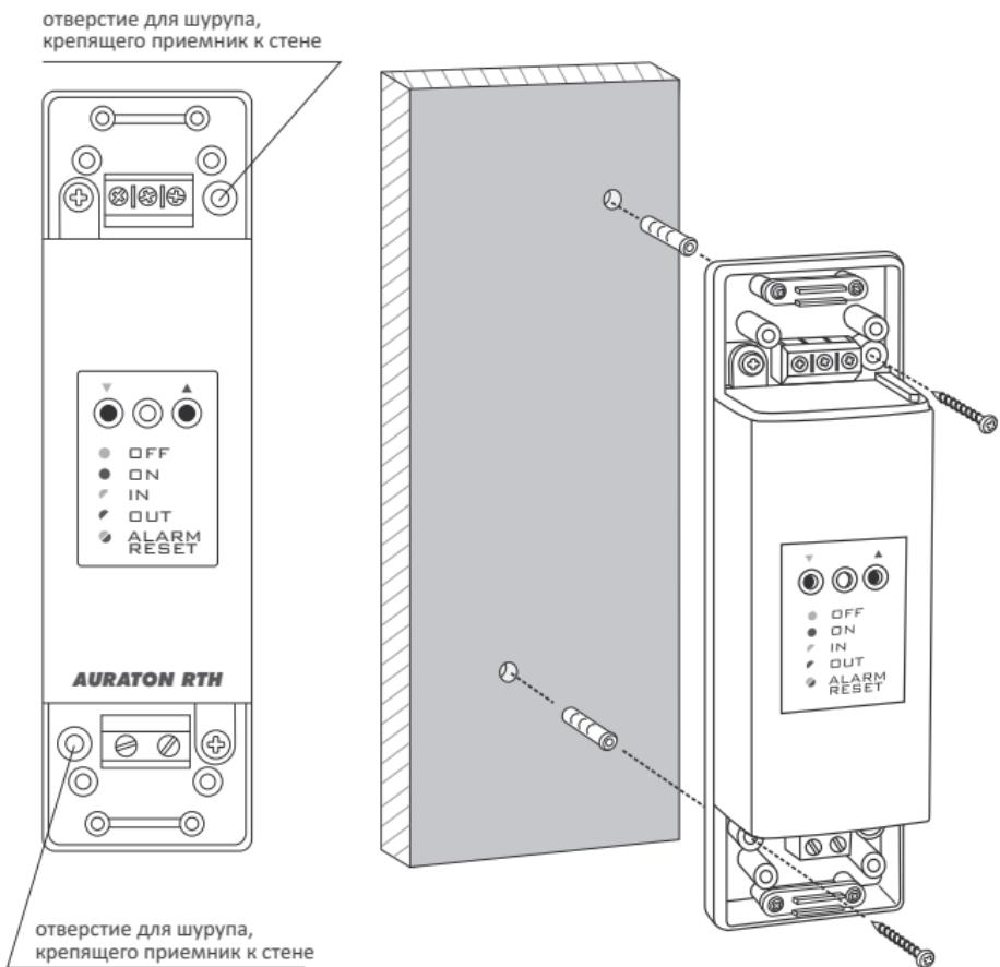
**Внимание:** Если стена деревянная, нет необходимости в использовании дюбелей. Следует вы сверлить отверстия диаметром 2,7 мм вместо 5 мм и шурупы ввинтить непосредственно в дерево.
